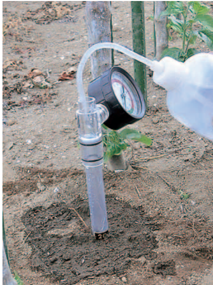
写真4 土壌水分計の設置状況
